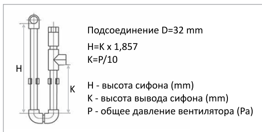
Отвод конденсата (рис. 5)
