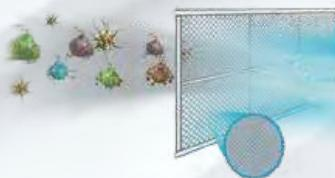
Це фільтр високої очистки нового покоління. У порівнянні зі звичайним фільтром очищення пилу, фільтр високого очищення видаляє більше 90% пилу та інших частинок з повітря в приміщенні. Фільтр просто очищається від забруднень під проточною водою.
