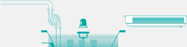
Поплавковий вимикач гарантує, що вода завжди знаходитьться нижче безпечної рівня, навіть якщо насос вийшов з ладу або злив заблоковано. Це подвійна страховка на випадок витоку води. Всі каналні блоки Aerostar в стандартній комплектації оснащені поплавковим вимикачем. Зливний піддон досить великий, щоб утримувати всю воду, яка повертається з дренажної труби при раптовому відключенні електроенергії.
